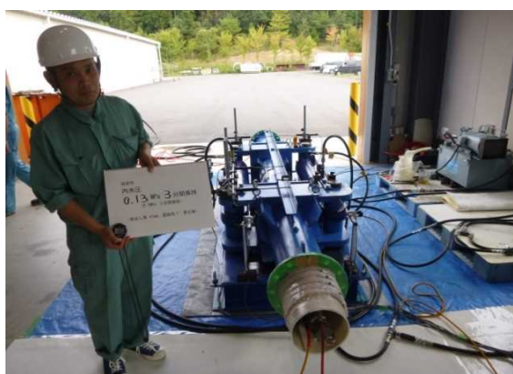
写真 2－1 拔出し長 1.5%(47mm) + 屈曲 1^{\circ} + 内水圧 0.1MPa
